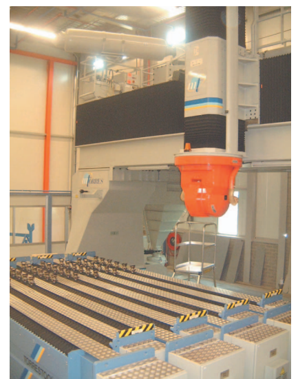
Bewerking van FML-materialen: bij Stork Fokker te Papendrecht wordt een speciaal bewerkingscentrum ingezet voor het frezen van Glare-platen.
