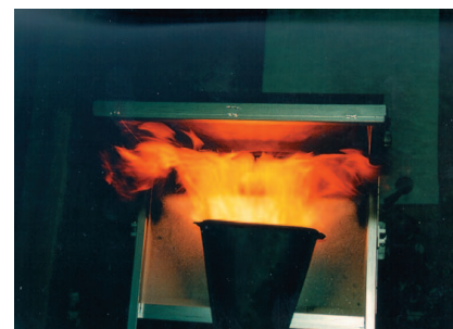
Eén van de excellente eigenschappen van FML-materialen is de brandwerendheid, zoals uit intensieve proeven blijkt.
