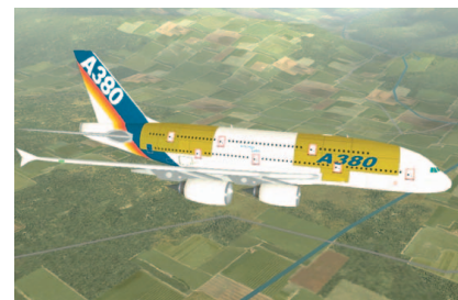
Model van het Airbus-vlaggeschip A380 met daarop aangegeven de rompdelen die van Glare worden vervaardigd.
